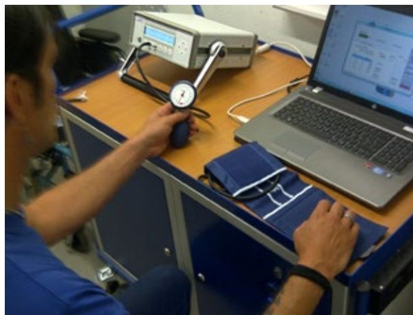
Aus der Praxis: So werden die Blutdruckmessgeräte im Pflegeheim Solina in Spiez (Schweiz) vom verantwortlichen Techniker kalibriert
